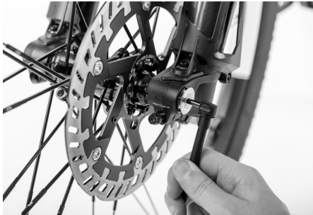
Abb. 50: Montage der Sicherungskappe
