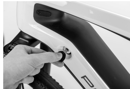
Abb. 29: Betätigen des Entnahmemechanismus
