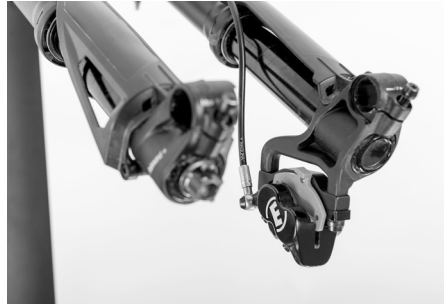
Abb. 64: Transportsicherung der Scheibenbremse
