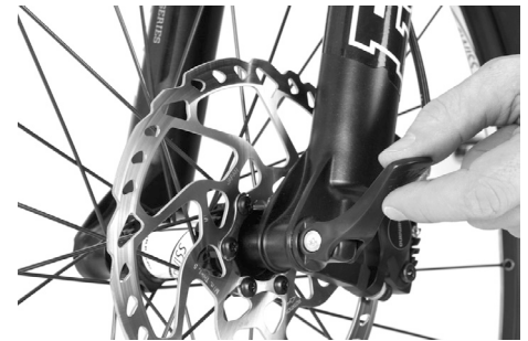
Abb. 53: Montage Vorderradachssystem Cross
