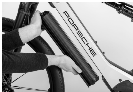
Abb. 31: Herausnehmen der Antriebsbatterie
