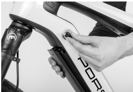
Abb. 33: Sichern der Antriebsbatterie
