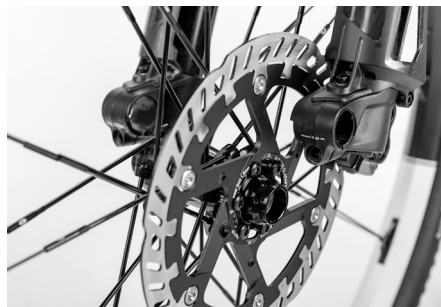
Abb. 48: Montage der Achsverschraubung / Vorderrad
