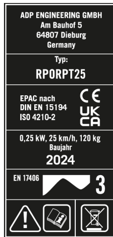
Abb. 1: Typenschild beispielhaft für PORSCHE EPACs
