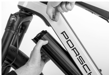
Abb. 31: Herausnehmen der Antriebsbatterie
