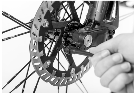
Abb. 52: Verstauen des Pannenzwerkzeugs
