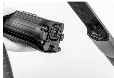
Abb. 32: Einbau der Antriebsbatterie
