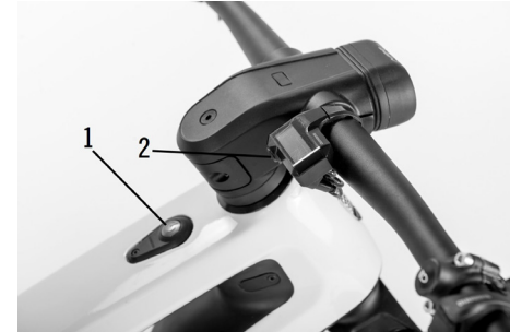
Abb. 5: Ein/Aus Taste (1) und Display Taste (2) Unterstützungsschalter (X / Y)
