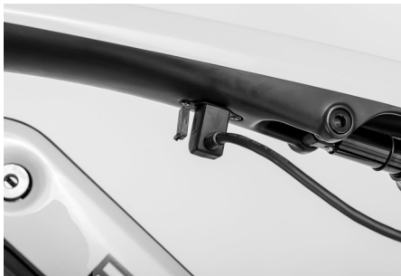
Abb. 27: Anschlussstecker in korrekter Position
