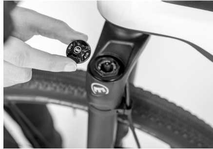
Abb. 43: Druckventil für Gabeldruckeinstellung
