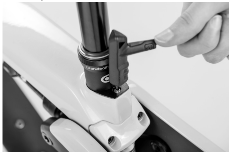
Abb. 11: Keilverschraubung Sattelstütze prüfen
