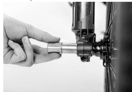
Abb. 49: Montage Vorderradachssystem Sport
