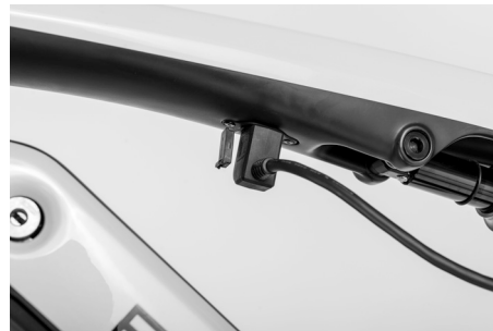
Abb. 7: Ladekabel Stecker / Antriebsbatterie
