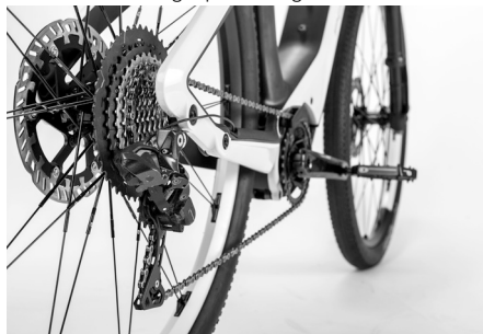
Afb. 18: Ketting op kettingblad/cassette
