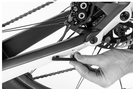
Afb. 56: Afdekking van de standaard
