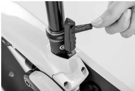
Afb. 11: Spieverbinding zadelpen controleren
