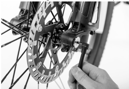
Afb. 50: Montage van de beschermkap
