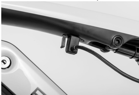
Afb. 27: Aansluitstekker in de juiste stand
