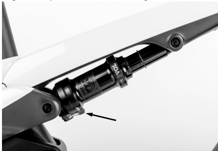
Fig. 46: Ajustes de la amortiguación
