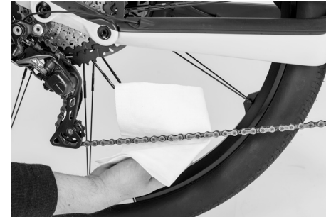
Fig. 21: Lubricar la cadena
