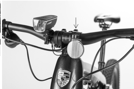
Fig. 62: Montaje del reflector frontal
