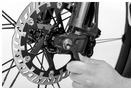
Fig. 8: Comprobar la tapa de seguridad de la rueda delantera
