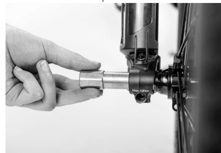
Fig. 49: Montaje del sistema del eje delantero de la Sport
