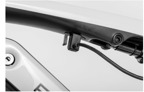
Fig. 7: Conector del cable de carga / batería de propulsión
