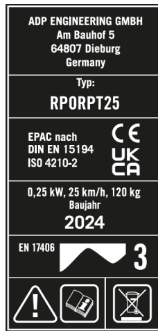
Fig. 1: Placa de características de ejemplo para PORSCHE EPAC
