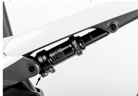
Fig. 47: Ajuste de la amortiguación
