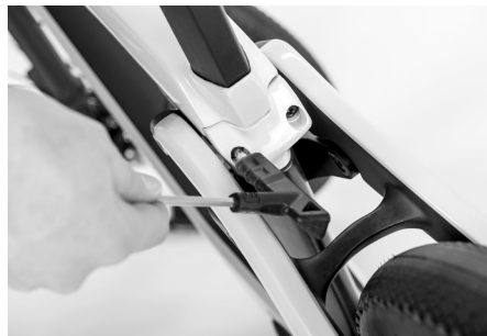
Fig. 40: Tornillos de sujeción / Tija de sillín AERO
