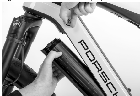
Fig. 31: Extraer la batería de propulsión
