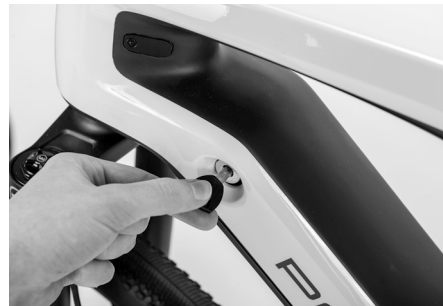
Fig. 29: Accionar el mecanismo de extracción
