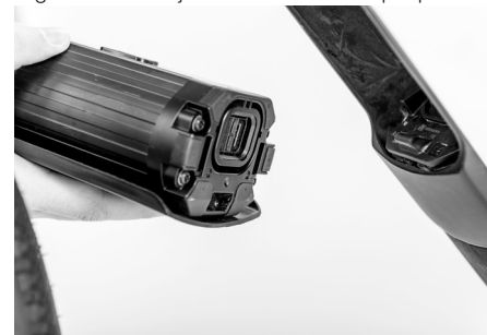
Fig. 32: Montaje de la batería de propulsión
