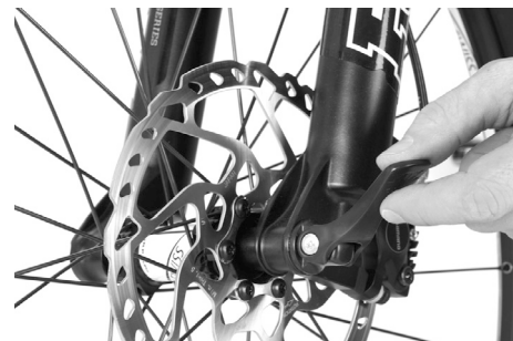
Fig. 53: Montaje del sistema del eje delantero de la Cross
