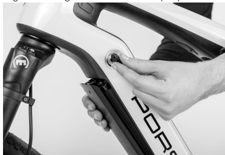
Fig. 33: Asegurar la batería de propulsión
