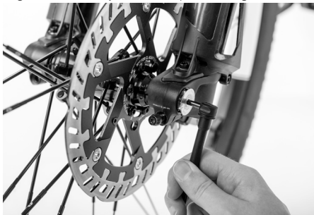
Fig. 50: Montaje de la tapa de seguridad
