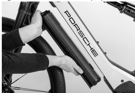
Fig. 31: Extraer la batería de propulsión
