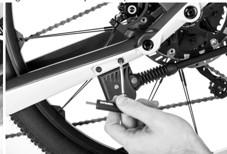
Fig. 57: Montaje de la pata de cabra
