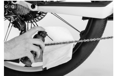
Fig. 21: Lubricar la cadena
